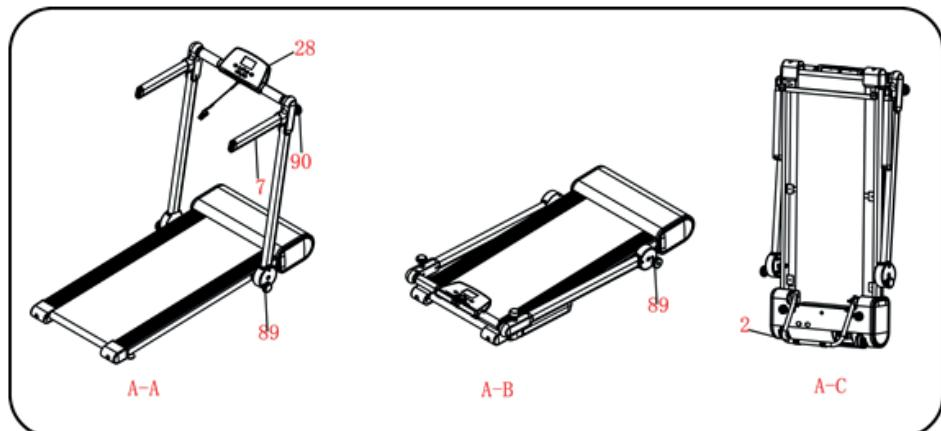
1. Опустите консоль компьютера (28). Открутите фиксаторы (90) на 10 оборотов. Сложите рукоятки и вертикальные опоры. Плотно закрутите фиксаторы (89). Поднимите беговую дорожку (рис. А-С): поддерживайте тренажер руками и ногой аккуратно раскрывайте опорную раму (2), пока не услышите звук фиксации.
