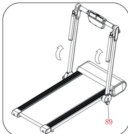
3. Вытащите фиксатор (90) и поднимите рукоятку (7). Плотно закрутите фиксатор (90). Повторите для другой рукоятки.
