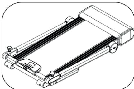
2. Поднимите корпус компьютера. Вставьте фиксатор (89) в левую и правую опору и тую закрутите.
