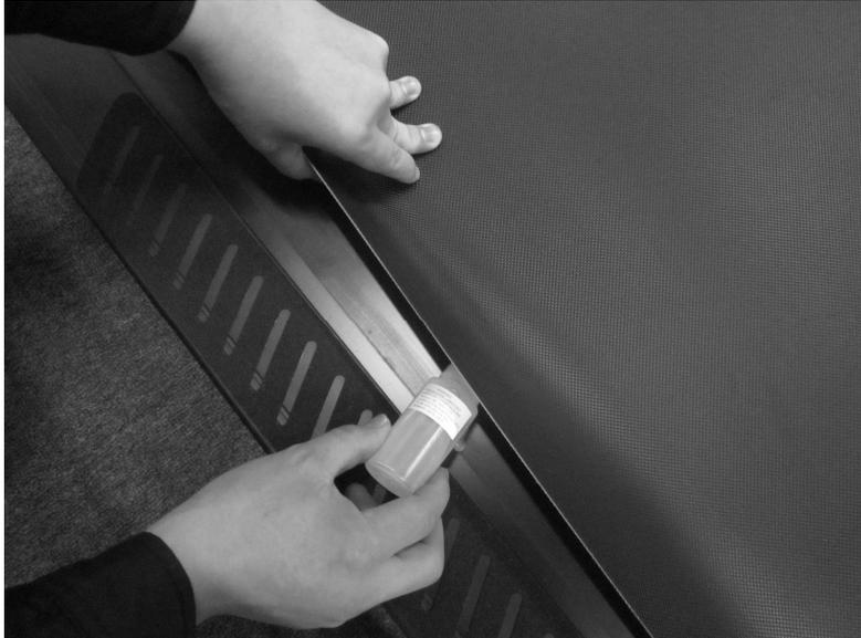
Беговая дорожка требует небольшого обслуживания. В частности необходимо применять смазку для механизмов бегового полотна. Использование смазки обеспечивает превосходную производительность беговой дорожки и продлевает срок жизни тренажера.
