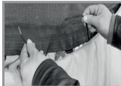
10. При помощи шнуров закрепите сетку через нижние отверстия и треугольные кольца полотна, как показано на фотографии.
