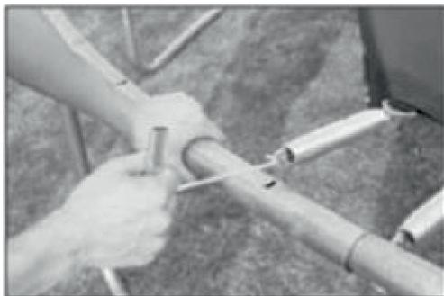
9. Повторите процесс со всеми пружинами, используя ключ для установки пружин.
