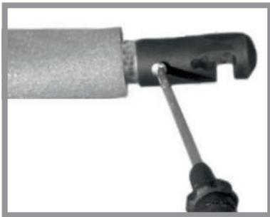
7. Наденьте наконечник на верхнюю стойку и прикрепите шурупом при помощи отвертки.
